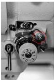
Grazie al sensore di rottura filo, la macchina si fermerà automaticamente.
