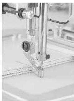
L'altezza del piedino e la pressione possono essere regolati tramite impostazione su pannello bordo macchina, senza utilizzo di particolari attrezzi.
